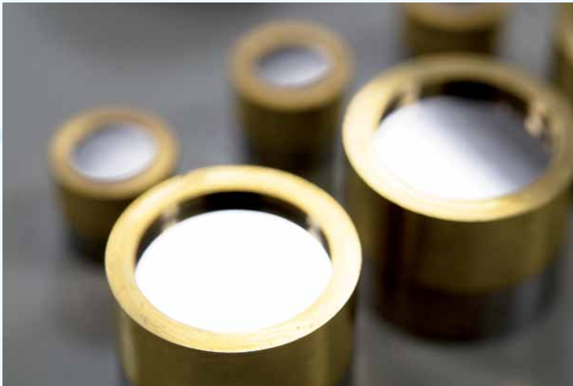
Примарни српски еталони звучног притиска (гарнитура 4180, гарнитура 4160) Primary Serbian sound pressure measurement standards (4180 set, 4160 set)
