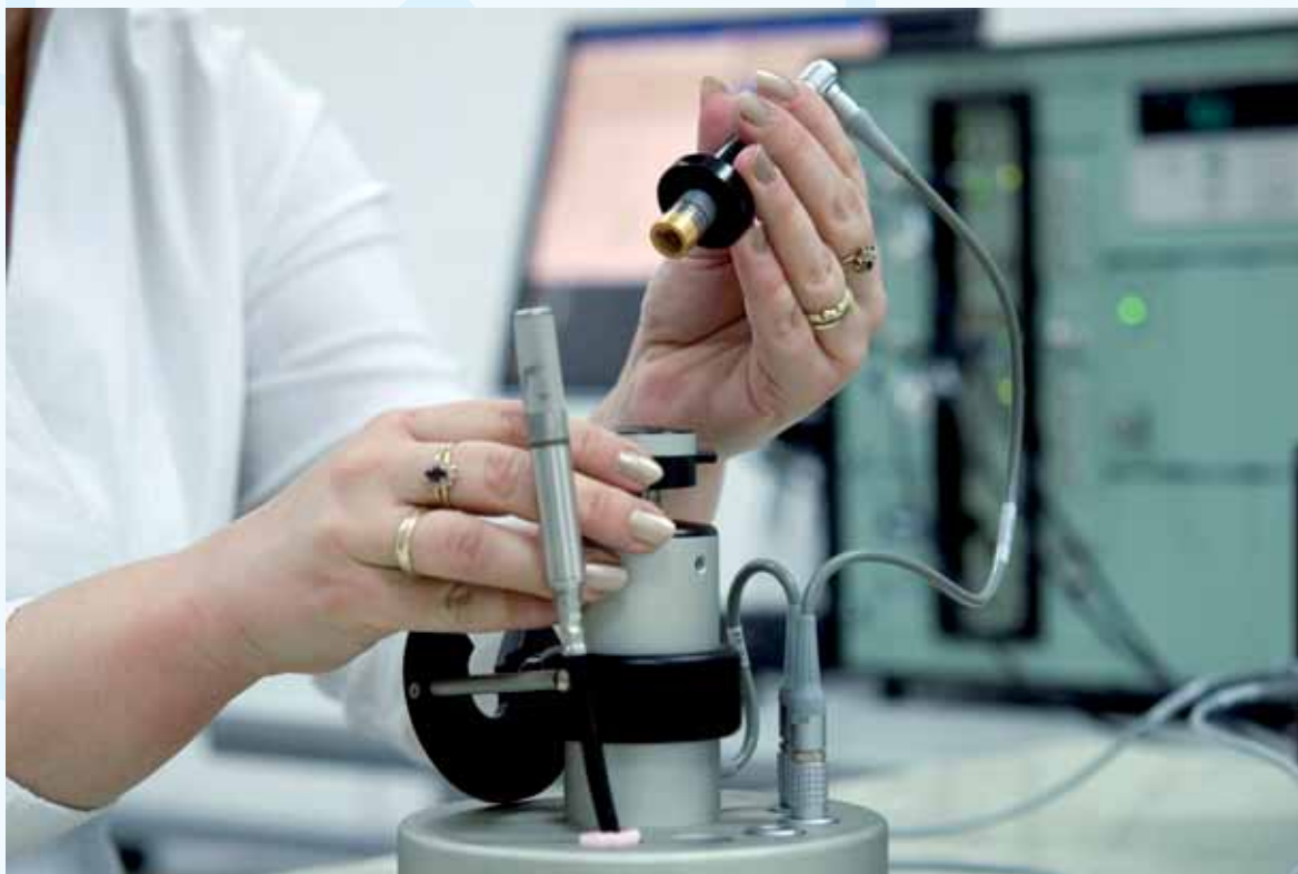
Примарна реципрочна метода еталонирања на притисак лабораторијских еталон микрофона тип LS1P и LS2P по стандарду IEC 61094-2 Primary pressure reciprocity calibration method of laboratory standard microphones of LS1P and LS2P types as per IEC 61094-2
